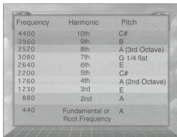
Рис. 76. Гармоническая структура ноты «А» акустической гитары.
