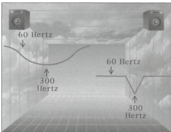
Рис. 81. Широкая и узкая полоса вырезания 300 Гц.
