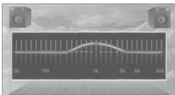
Рис. 67. Широкая полоса частот на графическом эквалайзере.
