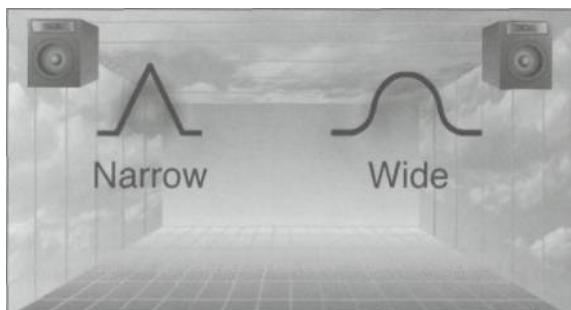
Рис. 70. Узкая и широкая полоса частот параметрического эквалайзера.
