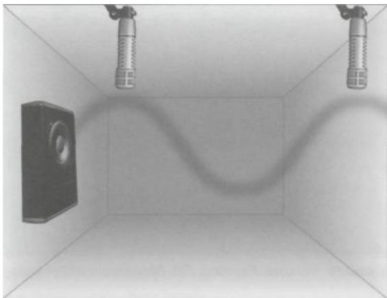
Рис. 84. два микрофона, снимающие звук в фазе.
