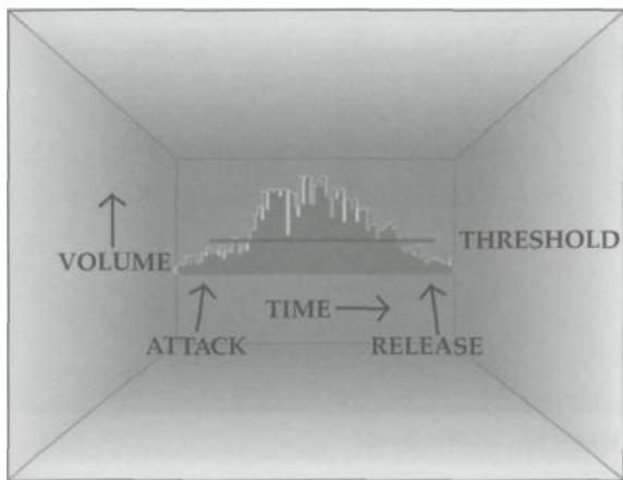
Рис. 64. Нойсгейт, отсекающий атаку и релиз звука.
